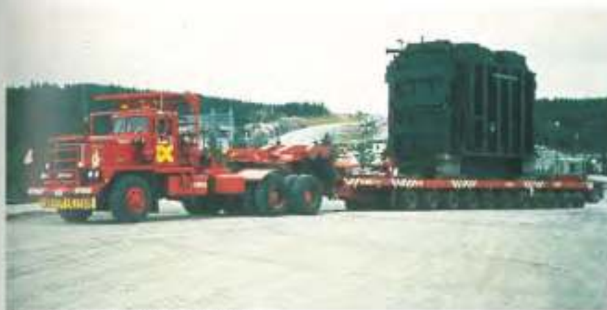
Transport sur fardier d'un transformateur
