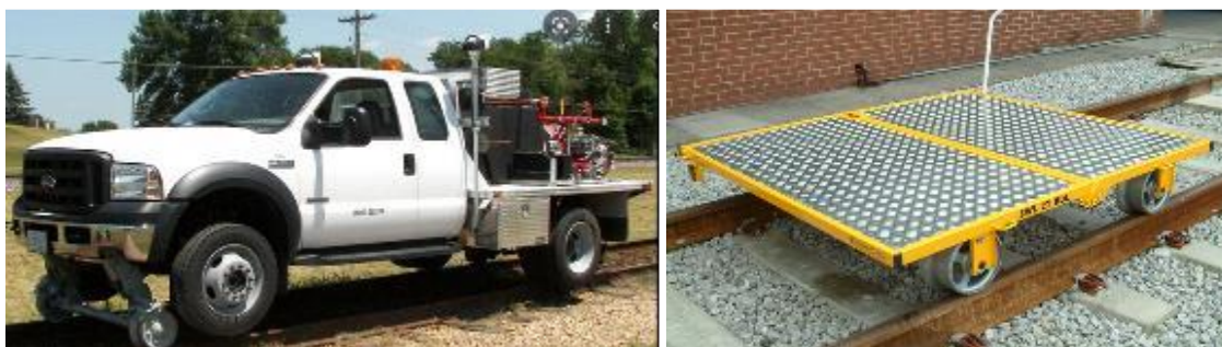
Figure 8.5-122 : Camion rail-route (à gauche), chariot d'entretien (à droite)
