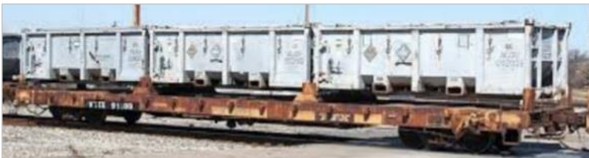
Figure 8.5-109 : Wagon plat de 20 m (64 pi) transportant trois conteneurs ISO (en haut), trois REU (en bas)
