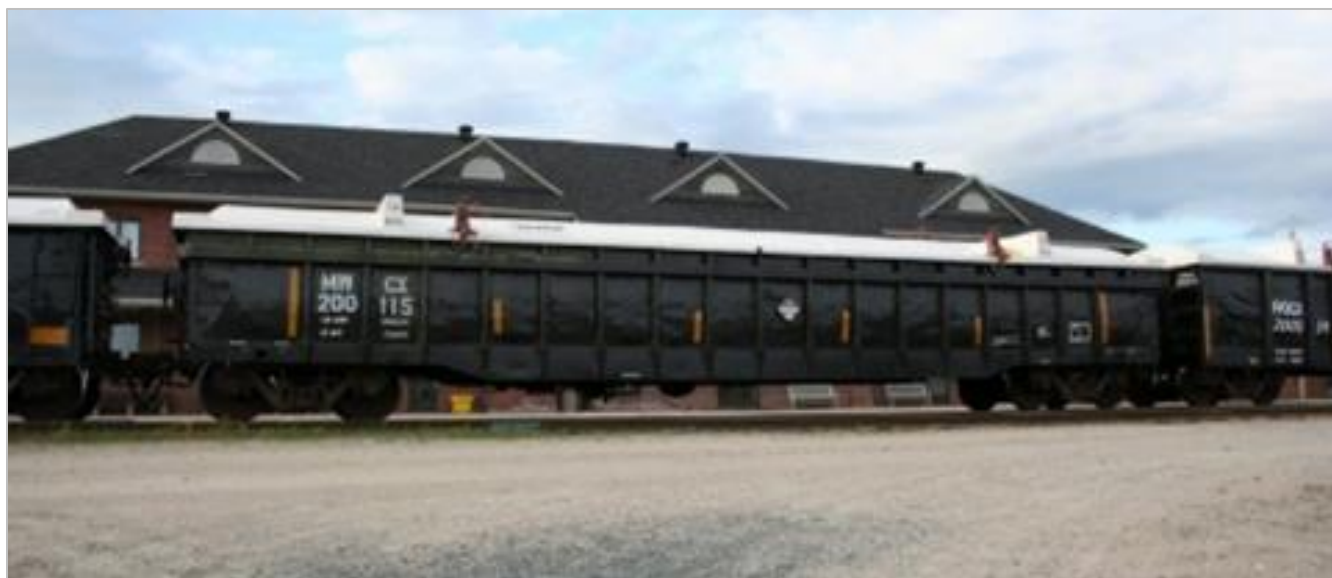
Figure 8.5-113 : Wagon-tombereau avec couvercle en plastique
