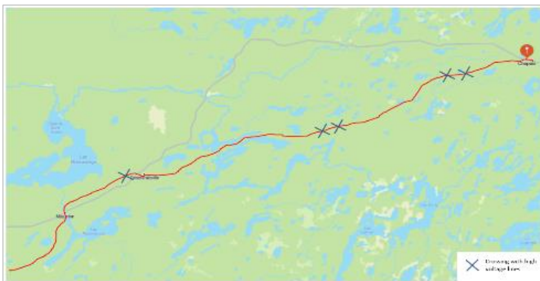
Figure 8.5-44 : Emplacement des lignes à haute tension traversant la ligne ferroviaire Grevet-Chapais
