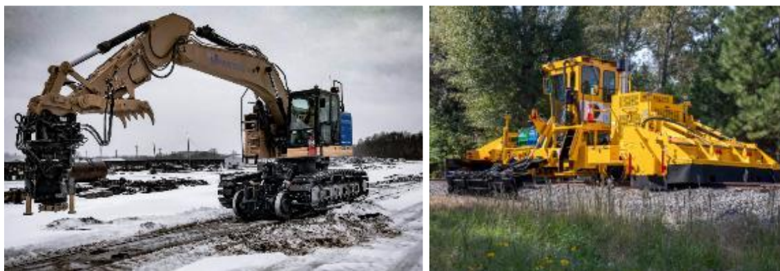
Figure 8.5-123 : Excavatrice de chemin de fer (à gauche), régaleuse à ballast (à droite)
