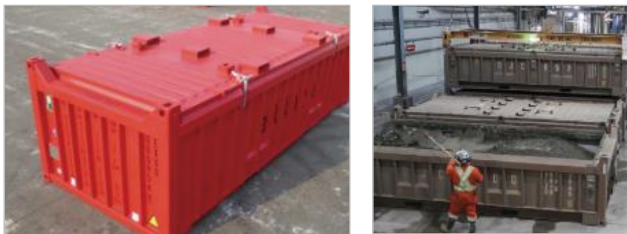
Figure 8.5-107 : Conteneurs renforcés pour le transport de spodumène
