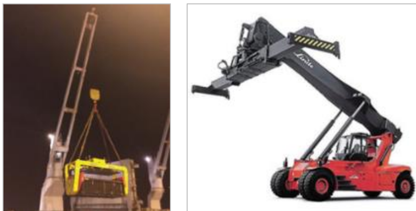
Figure 8.5-108 : Grue (à gauche), empileur de conteneurs (à droite)
