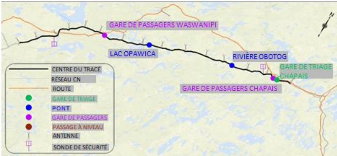
La ligne suit la plateforme existante à la fois en plan et en profil. Pour éviter les travaux de construction à l'extérieur de l'emprise existante et utiliser autant de ponts existants que possible, des restrictions de vitesse sont nécessaires sur environ 11,5 km.
