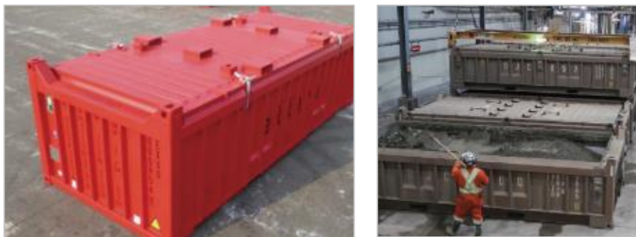
Figure 8.5-107 : Conteneurs renforcés pour le transport de spodumène
