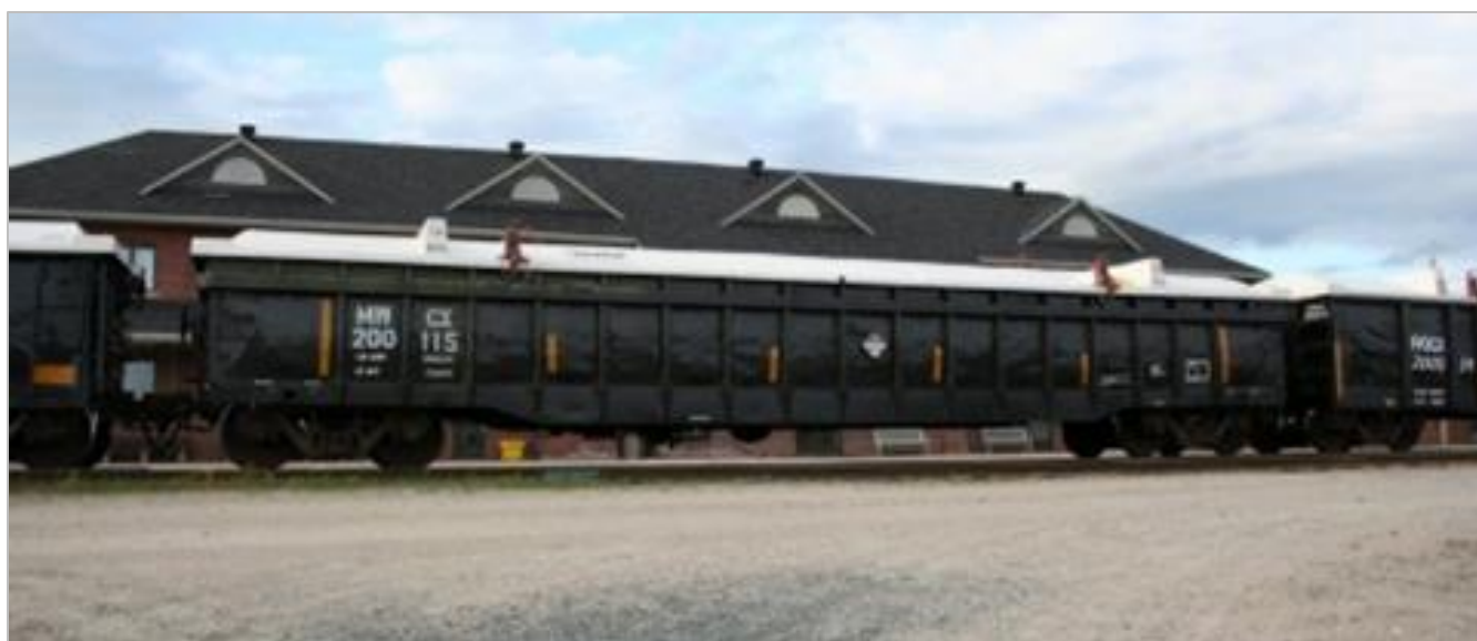
Figure 8.5-113 : Wagon-tombereau avec couvercle en plastique
