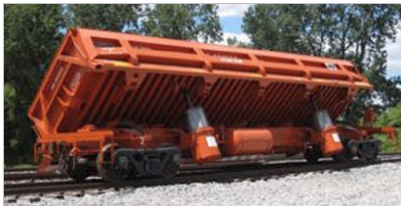
Figure 8.5-117 : Wagon à ballast à déversement sur le côté
