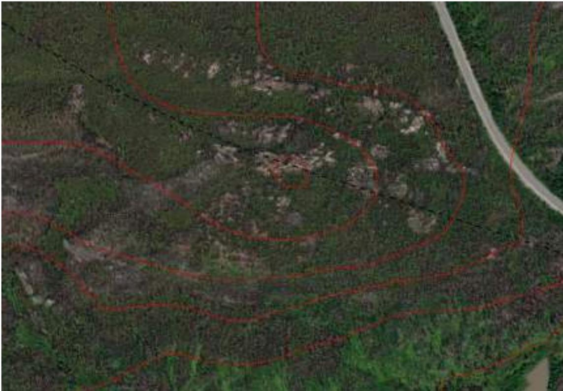
**Figure 3-2** Button de roc à pente abrupte traversé par le chemin de fer prévu (ligne pointillée noire) au centre du secteur de Rupert à La Grande, à 1 km au nord de la rivière Opinaca. Les lignes rouges illustrent les courbes de niveau au 10 m
